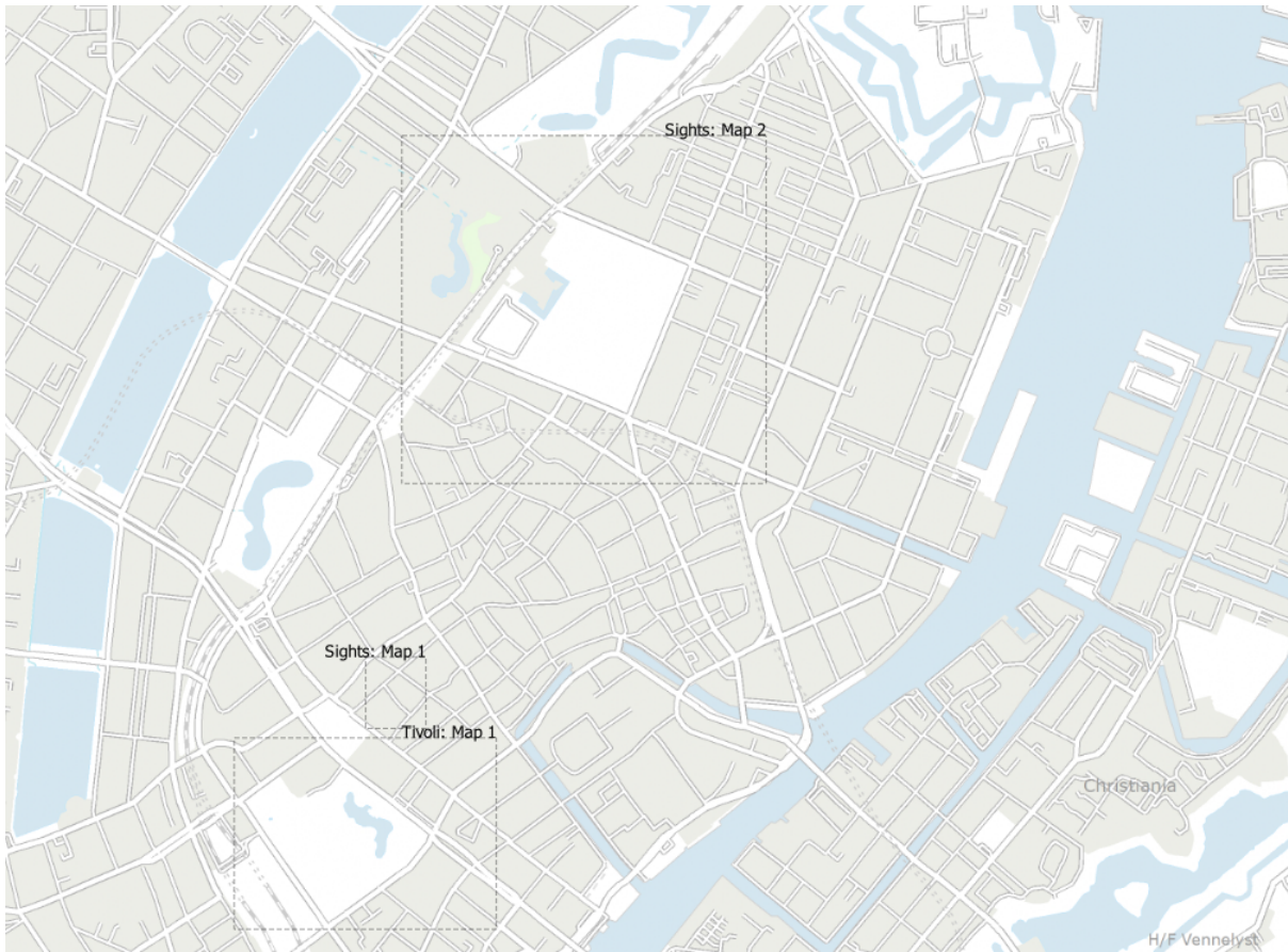
Figure 11.10: Esempio estensioni layout visualizzati in un progetto QGIS con due layout di stampa. Il layout di stampa denominato “Sights” contiene due oggetti nella mappa, mentre l’altro layout di stampa contiene un oggetto nella mappa.
