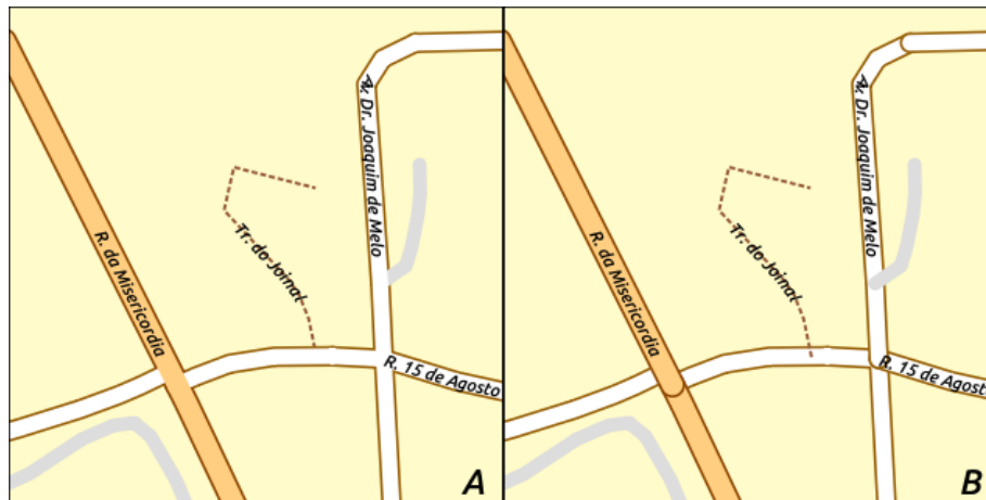
Figure 12.26: Différence de rendu selon que les niveaux de symboles sont activés (A) ou non (B)
